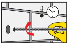
Engager immédiatement l'élément à sceller en lui imprimant un léger mouvement de rotation : veiller à introduire l'élément à sceller pendant le temps ouvert (voir § Vitesse de durcissement).
