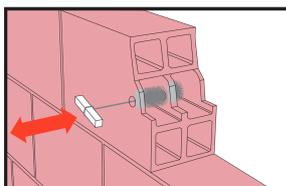
Nettoyer soigneusement le trou à l'aide d'une brosse ronde adaptée au diamètre du trou pour éliminer les particules de poussière (au moins 1 fois) ; le diamètre de la brosse doit être plus grand que le diamètre du trou.
