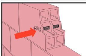
Insérer dans le trou un tamis de diamètre adapté (non fourni avec la cartouche) en laissant ouverte la bague centreuse.
