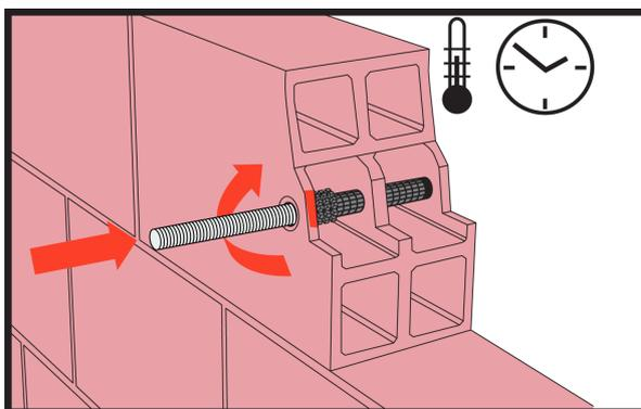
Engager immédiatement l'élément à sceller dans le tamis en lui imprimant un léger mouvement de rotation dans le sens horaire jusqu'au fond du tamis.
