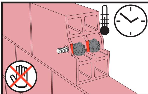
Pendant le temps de durcissement, l'ancrage ne doit en aucun cas être bougé ni mis en charge.
