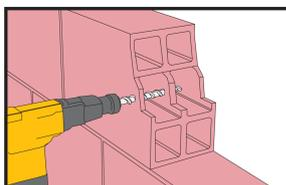
Percer le trou au diamètre et à la profondeur requis, en fonction de la dimension de l'ancrage.
