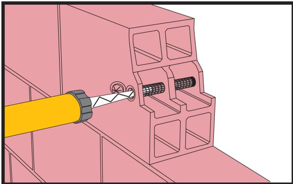
L'injection se fait en partant du fond tout en reculant progressivement la buse de mélange. Veiller à éviter les inclusions d'air dans la résine.
