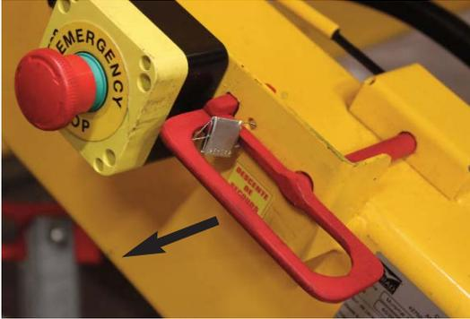
*Pour actionner la descente d'urgence, retirer l'écrou noir de maintien, arracher le plomb en prenant la poignée. Insérez la dans la fente en la maintenant appuyée.*
