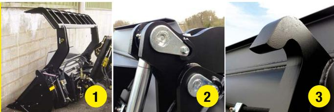
1. La mâchoire à ouverture totale facilite le chargement contre les murs (sauf contrainte technique de la cinématique machine)
