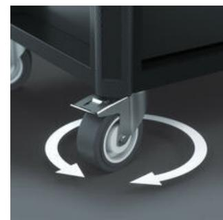
Les 2 roulettes pivotantes sont équipées d'un blocage double : le frein de la roulette empêche efficacement tout déplacement intempestif, le frein du palier d'articulation empêche la rotation non désirée des roulettes pivotantes, par ex. sur les surfaces en pente. Les roulettes élastiques résistantes aux huiles et aux acides permettent un roulement silencieux. Un anneau de protection empêche la saleté et les fils de pénétrer.
