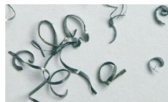
Des copeaux très fins ou poudreux indiquent une avance insuffisante
