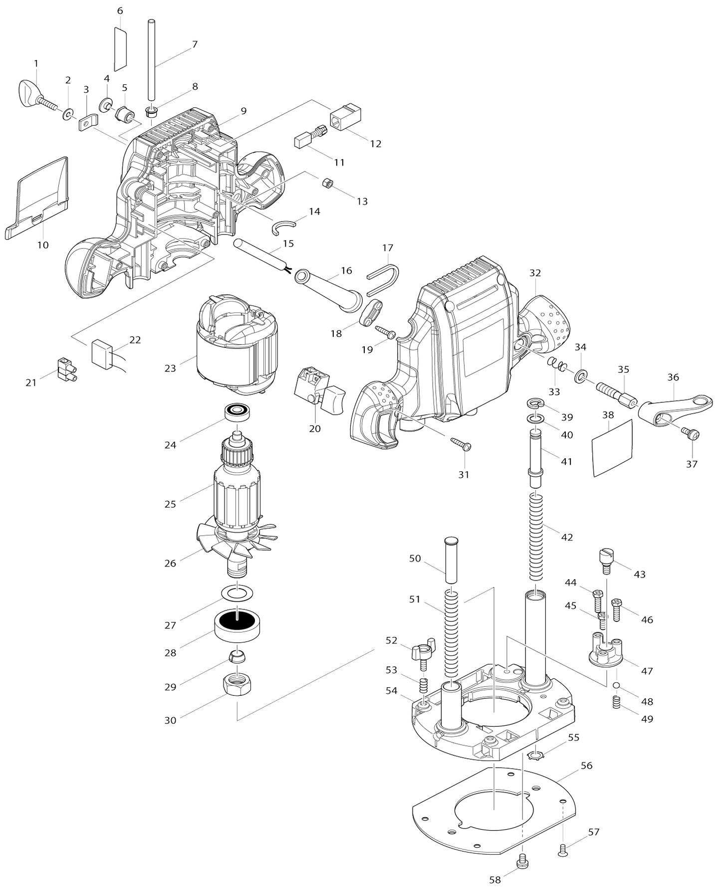
Model No.RP0900 DEFONCEUSE 900W-Q=6mm
