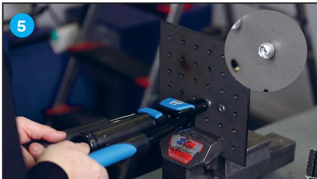
5 Refermez les bras de la pince pour sertir le rivet. Répétez l'opération si nécessaire jusqu'à rupture de la tige du rivet
