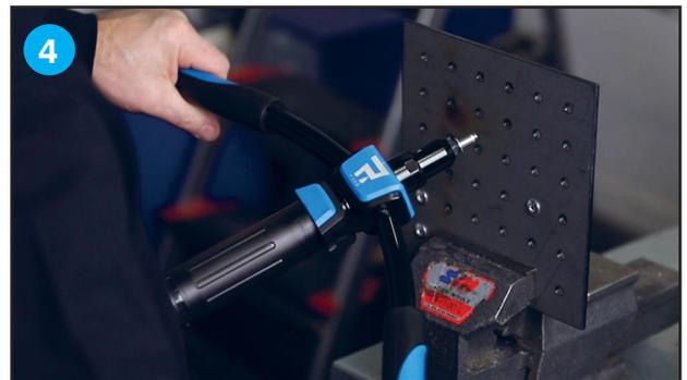
4 Insérez la tige du rivet dans le nez de pose de la pince et le corps du rivet dans le percement des éléments à assembler
