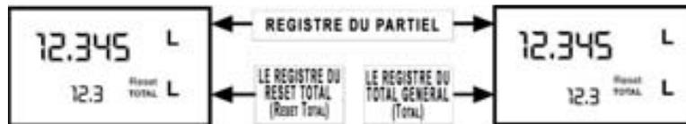
*Note : Les chiffres disponibles pour les totaux sont 6 auxquels il faut ajouter deux icônes x 10 / x100. La séquence d'incrémentatation est la suivante:*
