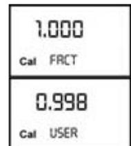
Si par contre, on a programmé un "user k factor", le facteur d'étalonnage programmé par l'utilisateur sera affiché (dans notre exemple 0.998). Le message «user » indique que le facteur d'étalonnage en cours est celui qui a été configuré par l'utilisateur.
