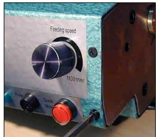
3. Retirer soigneusement le couvercle côté gauche avec la carte électronique.
