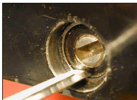
6. S'assurer que le support côté gauche de la table 25FV est propre et qu'aucun élément ne dépasse de la surface.
