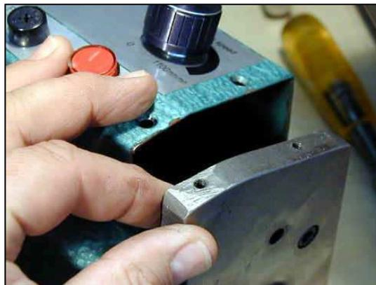
5. Retirer le bouchon situé sur le support côté gauche de la table 25FV. Utiliser un outil d'ébavurage pour enlever à l'intérieur de la fente de la peinture ou des débris qui gêneront l'installation de l'avance automatique.
