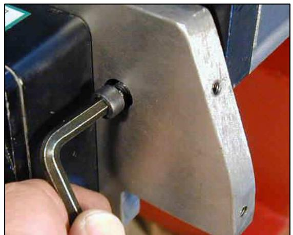
10. Remettre en place correctement le châssis sur la plaque support moteur et le visser.
