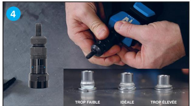
4 Pour régler la course: desserrez la bague puis tourner la partie graduée afin d'augmenter/réduire la course (réglage possible de 1 à 10mm). Se référer au schéma pour atteindre une déformation d'écrou optimale.
