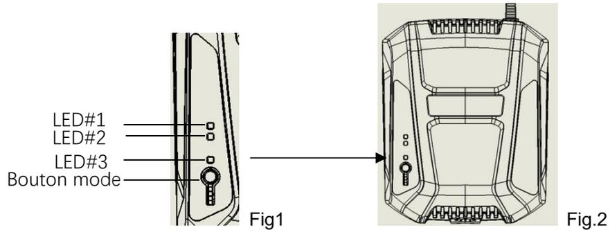
VOYANTS LED: Indique l'état de charge. Il y a trois LED.: LED#1 indique une charge standard, LED#2 indique une charge anormale, and LED#3 indique une charge rapide.
