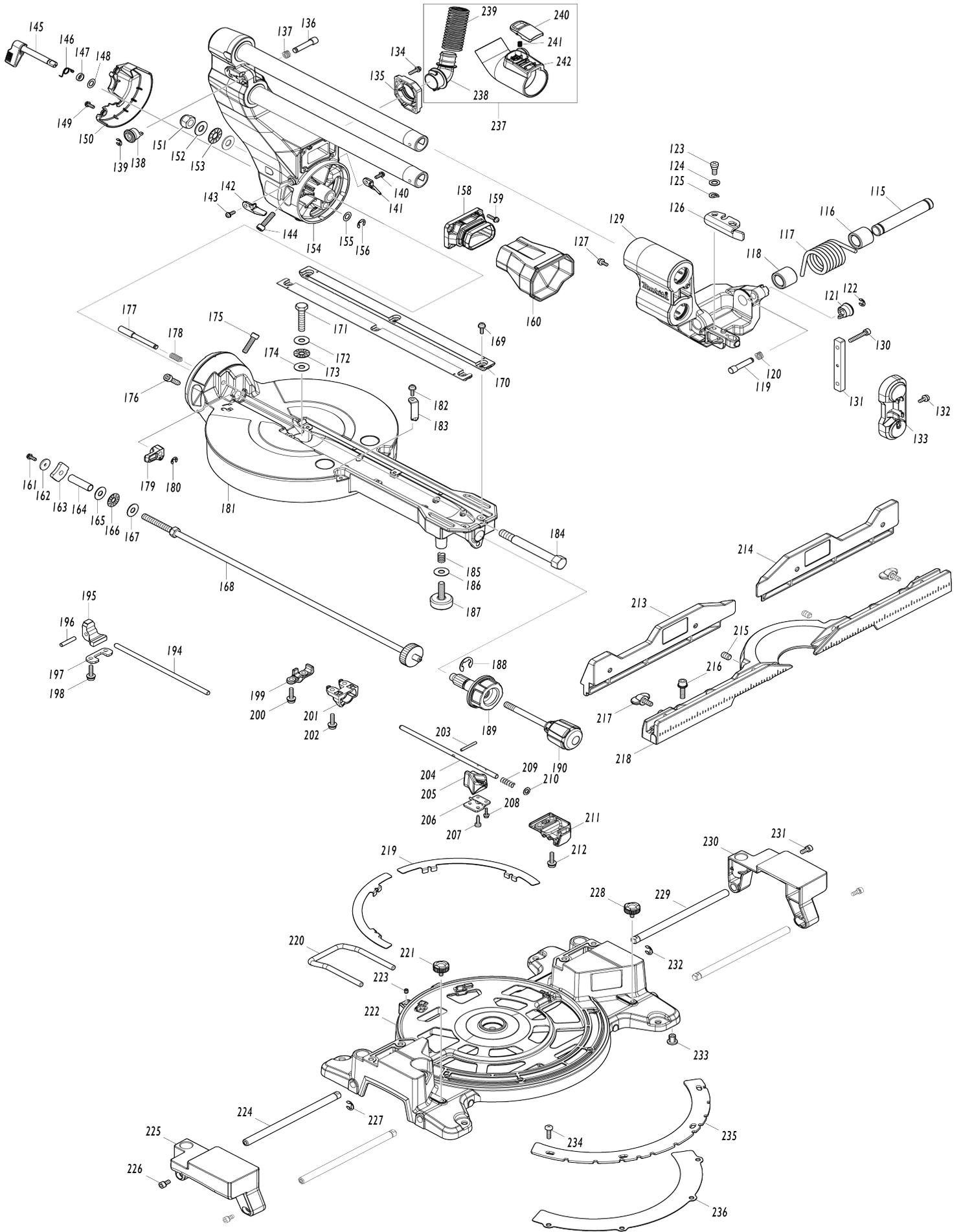
Model No.LS002G 216MM DC SLIDE CPD. MITER SAW
