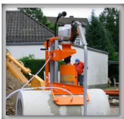
S'adapte aussi sur le bâti de la carotteuse de canalisation KB350 avec accessoire en option
