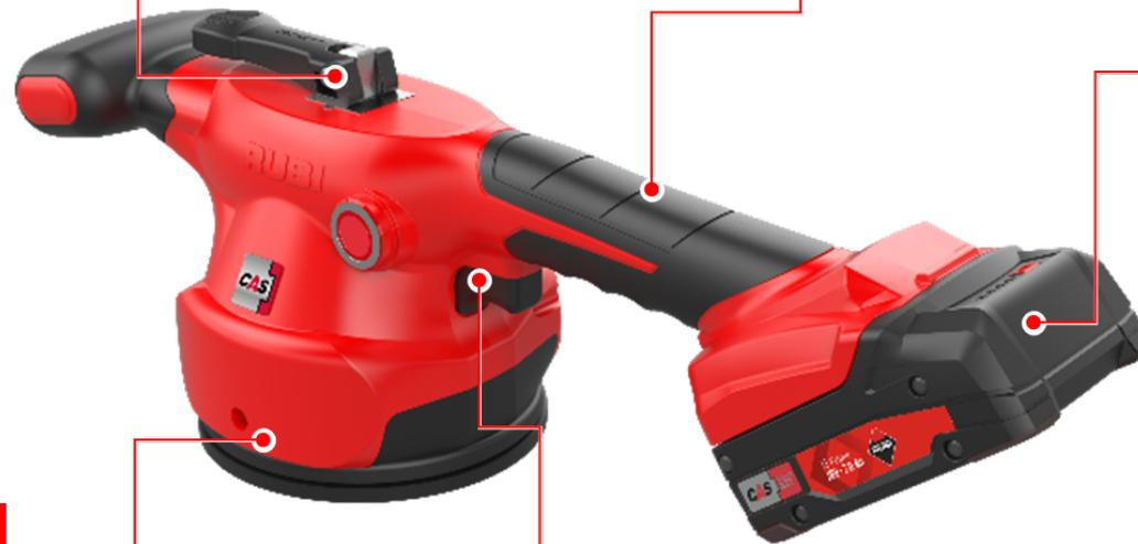
La **ventouse** de Ø 13 cm permet une opération à une main et a une capacité de charge de 50 kg.
