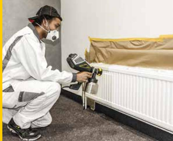
**Buse Visco reposant sur une Technologie d'avant-garde :** obtention d'un jet de haute qualité. C'est à la buse à fente de ce pistolet que le jet doit sa forme plate, laquelle garantit aussi une vitesse de travail élevée
