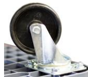
NY - Roues nylon CU 350 kg - Bandage dur pour sols lisses
