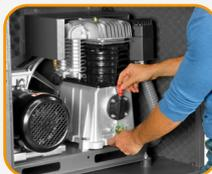
Filtre à air à faibles pertes de charge
