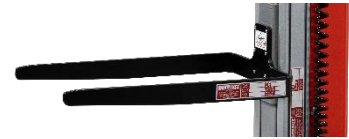
Fourches pour bacs à rebord - 855 010 463 Longueur : 480 mm Largeur intérieure : 272 mm Largeur extérieure : 288 mm
