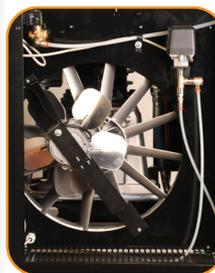
Le compresseur est équipé d'un électro-ventilateur qui tourne en permanence. Ce dispositif vient en plus du refroidissement par le **grand volant** du groupe à **ailettes orientées**.
