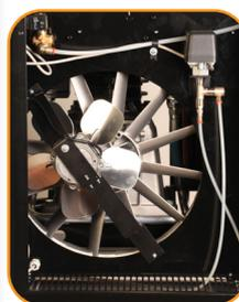
Le compresseur est équipé d'un électro-ventilateur commandé par une **sonde de température**, qui se déclenche dès que la température interne du caisson dépasse les 40°C.
