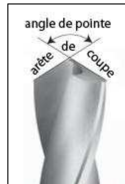
\alpha (alpha) : angle de pointe du foret a et b : longueurs des arêtes de coupe
