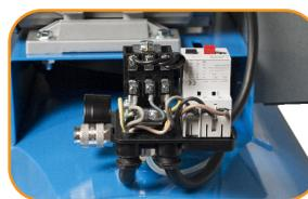
Le WM 55/500 est équipé de série d'un contacteur-disjoncteur.
